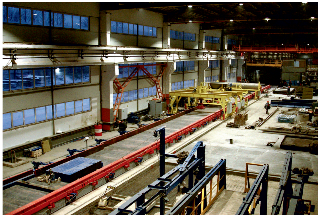
Техническое перевооружение и реабилитация действующего ДСК без остановки производства. Универсальный стан с отодвижными и откидными бортами, с работой затирочной машины, вибробетоноукладчика, размотчика термопокрывала и др. /Киришский ДСК. Февраль 2020 г. /
