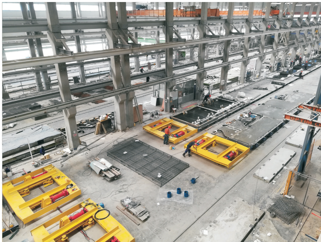
Технологическое перевооружение с монтажом универсальных стандов ЗАО «Рекон» по выпуску преднапряженных и ненапряженных плит перекрытий и ВС для 18–25-этажных жилых домов КПД со встроенным 1 этажом / ГК «ПИК-Индустрия». г. Наро-Фоминск, Московская область. 2019 г./
