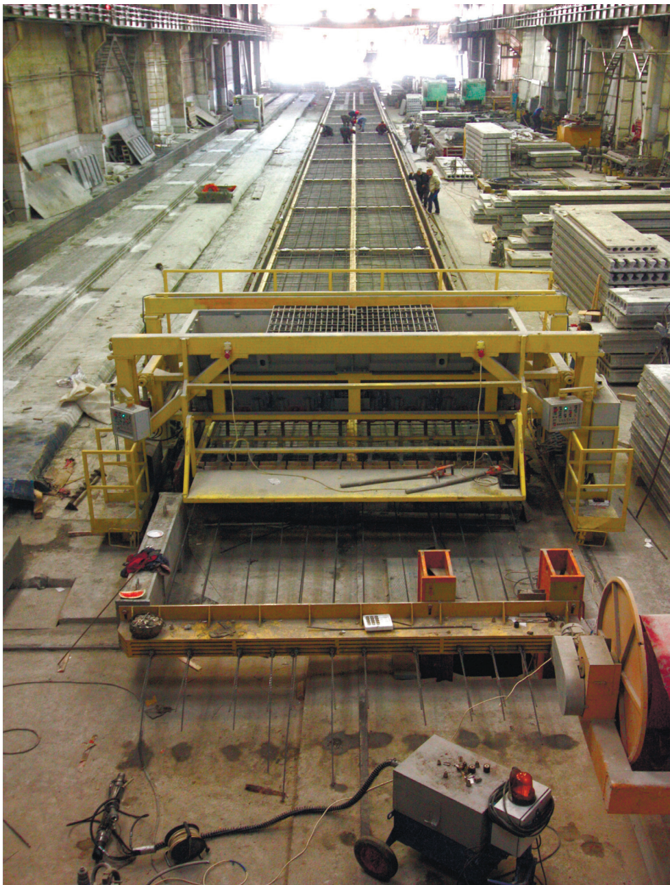
Подготовка к формированию преднапряженных пазогребневых плит с постнапряжением на универсальном стенде / ОАО «Монолитстрой», г. Чебоксары, октябрь 2014 г. /
